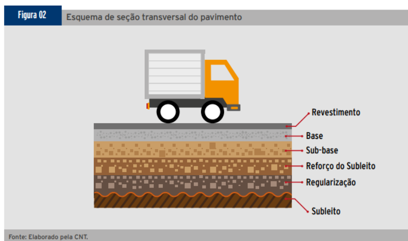
Figura 1 – Estrutura de Pavimentação.
