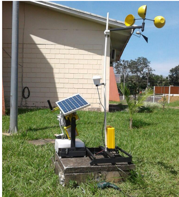
Figura 1 – Protótipo do anemômetro instalado na Fatec.
